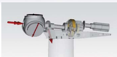
Modell zur Ergebnisvisualisierung mit DynDP: Dynamische Lastsimulation vom Windfeld bis zum einzelnen Kontakt im Wälzlager.
