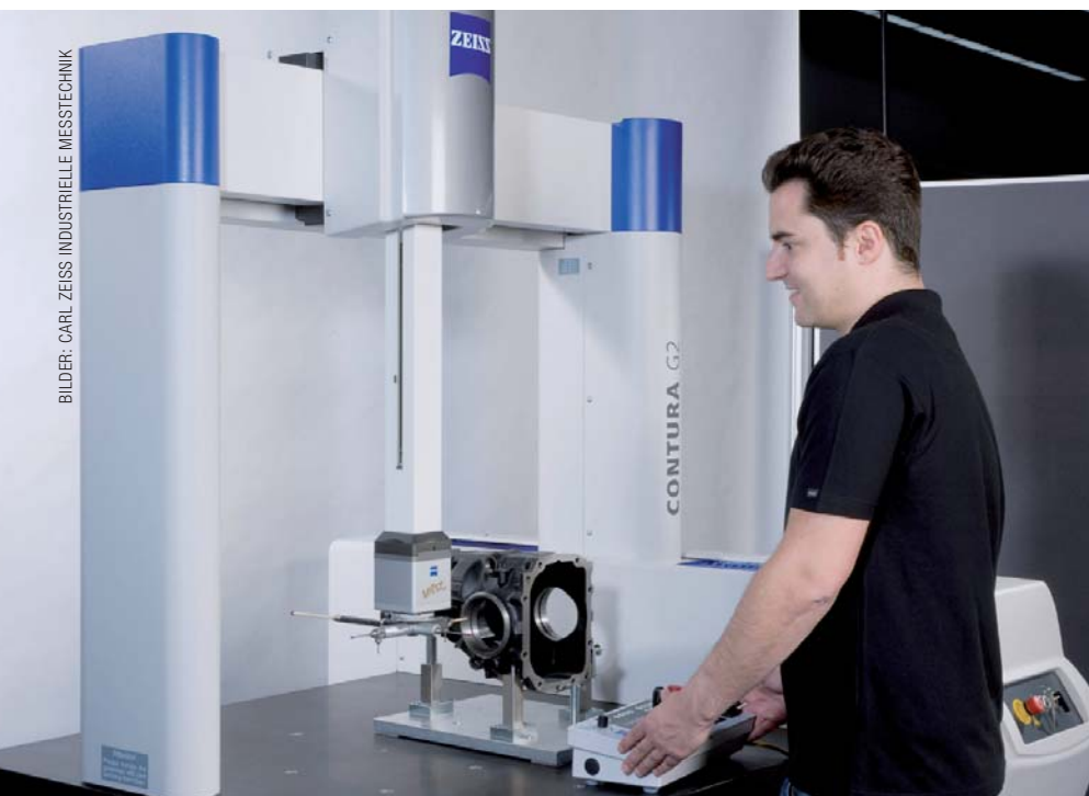
Das neue Scanningmessgerät Contura G2 navigator für sehr schnelles und sehr genaues Messen.
