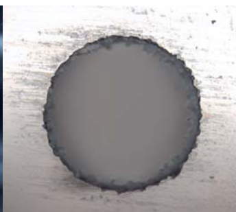
Bohrung durch ein Millimeter dickes Glas (Wellenlänge 349 nm, Trepanation mit Fokus 25 µm). Die Vergrößerung der Bohrung zeigt an der Eintrittsseite keine Rissbildung im Glas.
