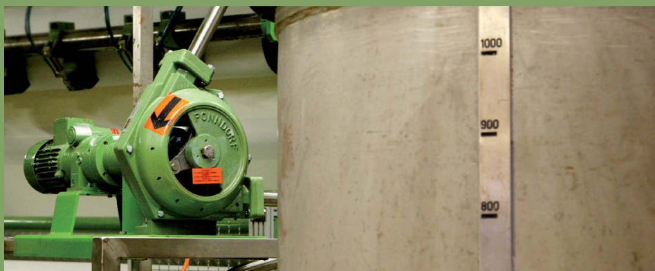
Schonend fördern die Schlauchpumpen die scherempfindliche Farbe zu den Farbwerken der Tiefdruckmaschine
