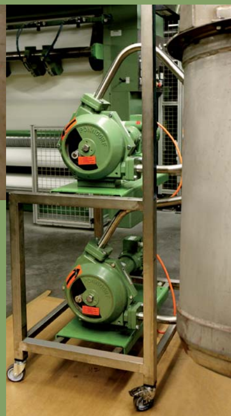
Schonend fördern die Schlauchpumpen die scherempfindliche Farbe zu den Farbwerken der Tiefdruckmaschine
